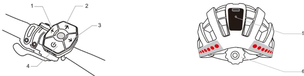
Nota: Si el casco no obedece a las pulsaciones de los botones, un pequeño LED rojo cerca del botón que pulse parpadeará rápidamente. En este caso, compruebe si el casco y el mando no están emparejados o si el casco no tiene energía. El LED rojo cerca del botón parpadea durante la carga, y se apaga cuando esté totalmente cargado.
