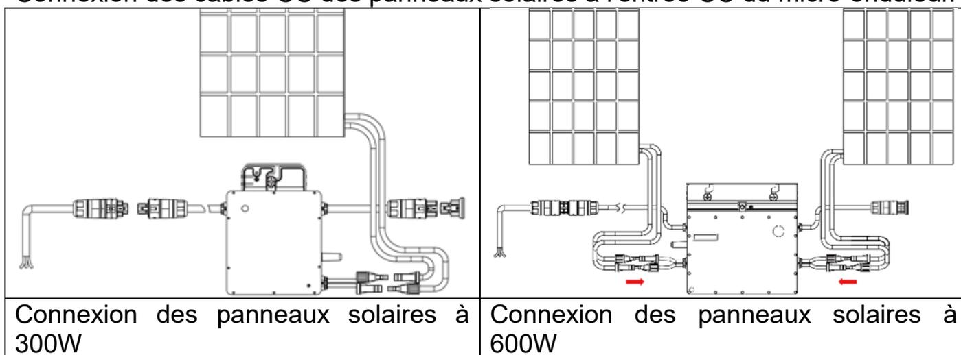
Le 300W se connecte aux panneaux solaires via des connecteurs MC4. Le micro-onduleur 600W fournit deux paires de connecteurs MC4 pour deux panneaux solaires. Connectez simplement les câbles de connexion CC du micro-onduleur à la partie correspondante du panneau solaire. En même temps, connectez la paire de connecteurs ensemble jusqu'à ce que vous entendiez un "clic". Sur certains
