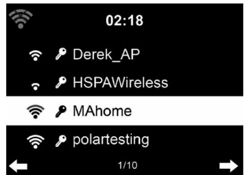
**Nota:** ● Il numero di tacche nel simbolo wireless di fronte al nome della rete (SSID) mostra la potenza relativa del segnale di rete. ● Il simbolo della chiave indica che la rete è protetta da una password. ● Se il TX-178 non trova nessuna rete WiFi e appare sul display “Nessuna Rete wireless trovata” cambiare, se necessario, la posizione del TX-178 e controllare il proprio router WiFi. In seguito, ricercare nuovamente il WiFi.
