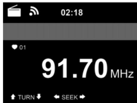
In alternativa, è possibile impostare le stazioni radio FM manualmente. Premere ◀ o il pulsante ▶ sul dispositivo oppure utilizzando il ◀ o il pulsante ▶ del telecomando per cercare la stazione FM. Ogni incremento corrisponde a 0,05 MHz.
