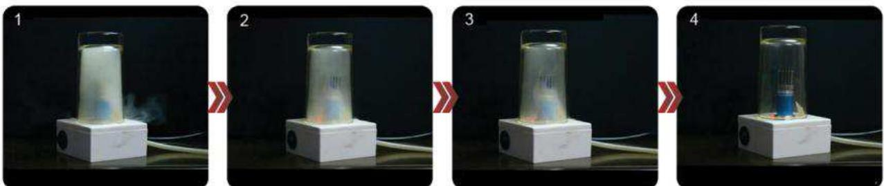
Soplar humo en un vaso → encender el ionizador → el humo empieza a desvanecerse → el humo es eliminado completamente en segundos.
