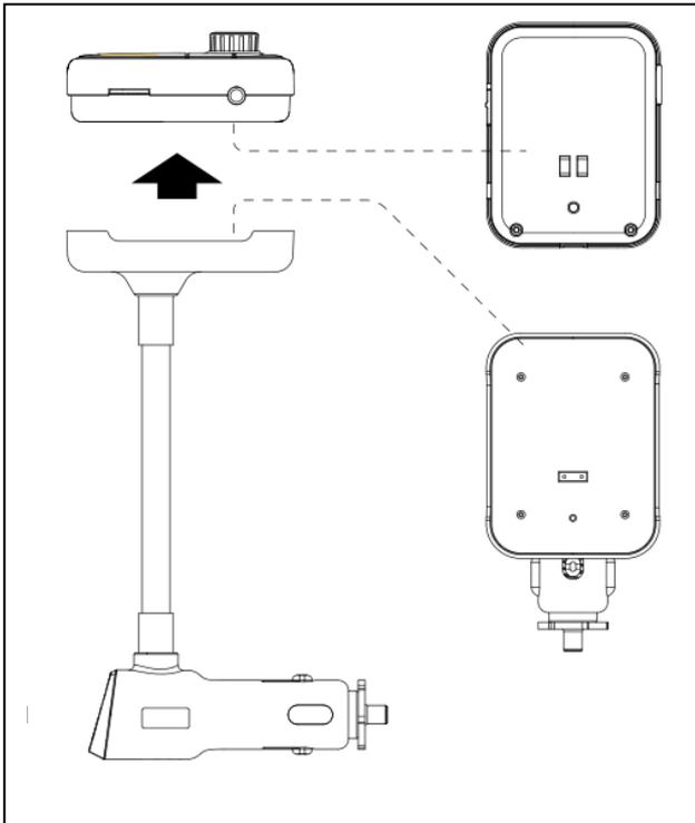
Das Gerät besteht aus zwei Teilen: Dockingstation (mit Halterung) und der FM-Einheit (hält magnetisch auf der Dockingstation und kann so leicht abgenommen werden).
