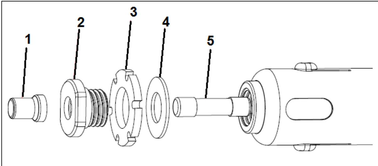
1. Spitze, 2. Schraubverschluss, 3. Silikonring, 4. Dichtung, 5. Sicherung
