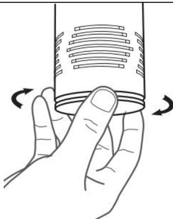
Schrauben Sie die untere Abdeckung fest, bevor Sie das Gerät wieder einschalten.
