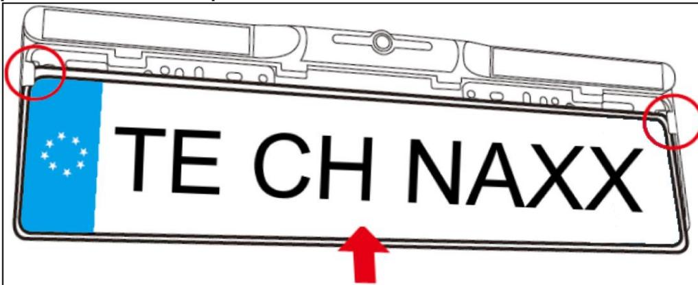
3. Introduzca los clips de la banda de cubierta superior en los agujeros correspondientes del soporte de matrícula y apriételos.
