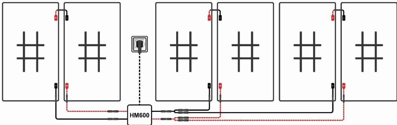
**Important !** Pour faire fonctionner correctement le système d'alimentation solaire, il est nécessaire de raccorder les fiches dans l'ordre indiqué.
