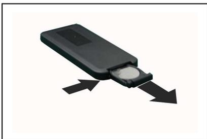
→ Rimuovere il coperchio del vano batteria tirando il coperchio in direzione della freccia. → Rimuovere la batteria. → Inserire la batteria di ricambio. Prestare attenzione alla direzione della polarizzazione corretta (+/-). → Rimettere il coperchio sul vano della batteria.
