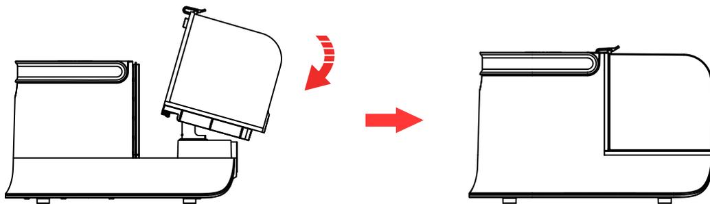
Platzieren Sie den Staubbehälter wie in den Abbildungen von oben in die Saugereinheit.
