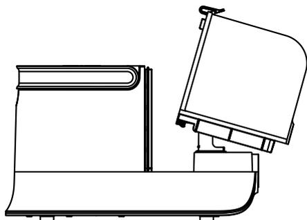
Setzen Sie den Staubbehälter wieder ein, indem Sie ihn wieder auf die Saugereinheit setzen, bis der Verriegelungsmechanismus hörbar ist.
