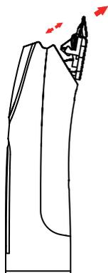
Nehmen Sie die Messereinheit ab, indem Sie den Scherer festhalten und mit dem Daumen in Richtung Klinge drücken und aus dem Scherer entfernen.
