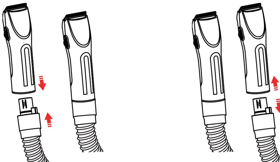
Stecken Sie den Schlauch in die Schermaschine (Bürsten), um ihn zu installieren
