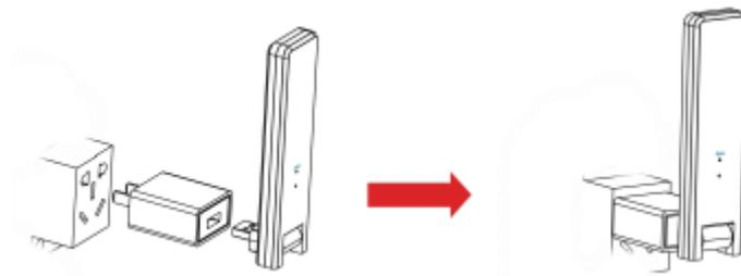
Wenn Sie eine Steckdosenleiste verwenden, achten Sie darauf, dass diese mindestens 1 Meter über dem Boden angebracht ist. Versuchen Sie, die DTU in einem 90-Grad-Winkel senkrecht zum Boden zu installieren, wie unten dargestellt.
