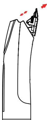
Separe la unidad de cuchillas sujetando la cortadora y empuje con el pulgar hacia la cuchilla y retírela de la cortadora.
