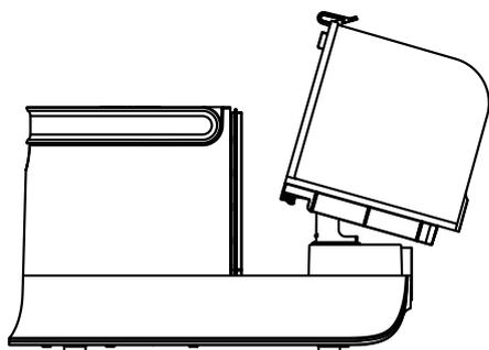
Vuelva a instalar el depósito de polvo y colóquelo nuevamente en la unidad de aspiración hasta que escuche el mecanismo de bloqueo.
