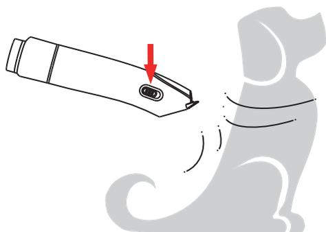
Deslice el interruptor de encendido para activar y desactivar la cortadora. La cortadora solo funcionará cuando la aspiradora esté encendida.
