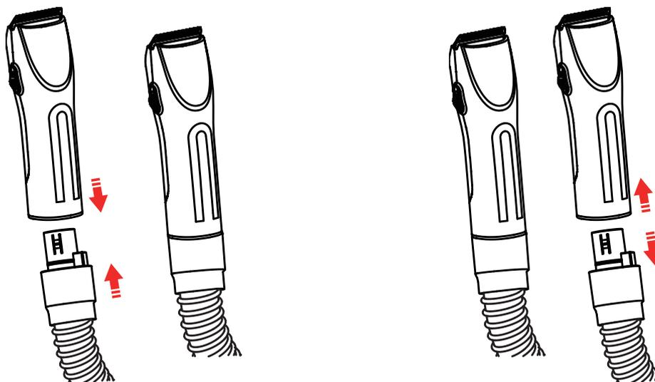
Inserte la manguera en la cortadora (cepillos) para instalar
