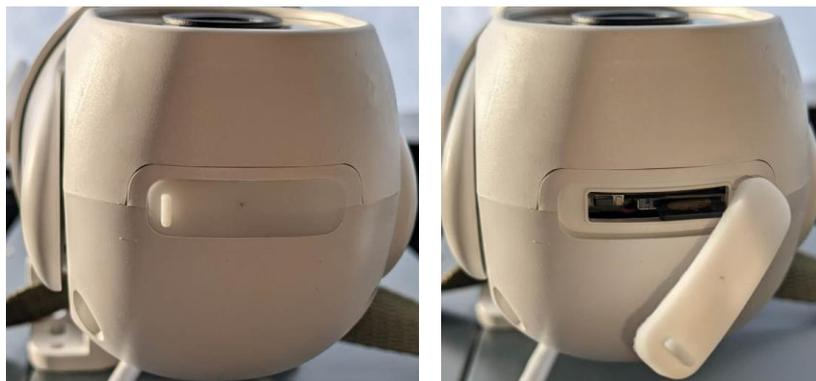
Después de insertar la tarjeta MicroSD con las muescas hacia la izquierda, como se ve en la imagen, cierre nuevamente el compartimento.
