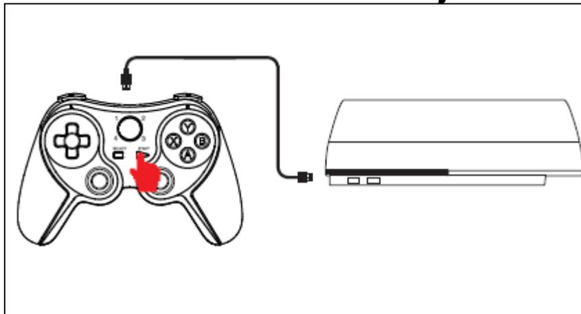
Appuyez sur le bouton Start (Démarrer) de l'appareil et branchez-le à un port USB de la console à l'aide du câble USB. Le voyant LED s'illumine.
