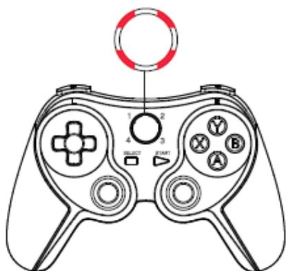
Branchez l'appareil via Micro-USB à l'interface USB de votre ordinateur. L'appareil commence à se charger. Les quatre voyants LED clignotent simultanément. Les voyants s'éteignent lorsque la charge est terminée. Lorsque le niveau de la batterie baisse, les voyants LED clignotent rapidement. L'appareil passe en veille lorsqu'il n'est pas utilisé pendant 5 minutes. Appuyez sur le bouton Alimentation/Association pendant 2 secondes pour allumer l'appareil de nouveau.
