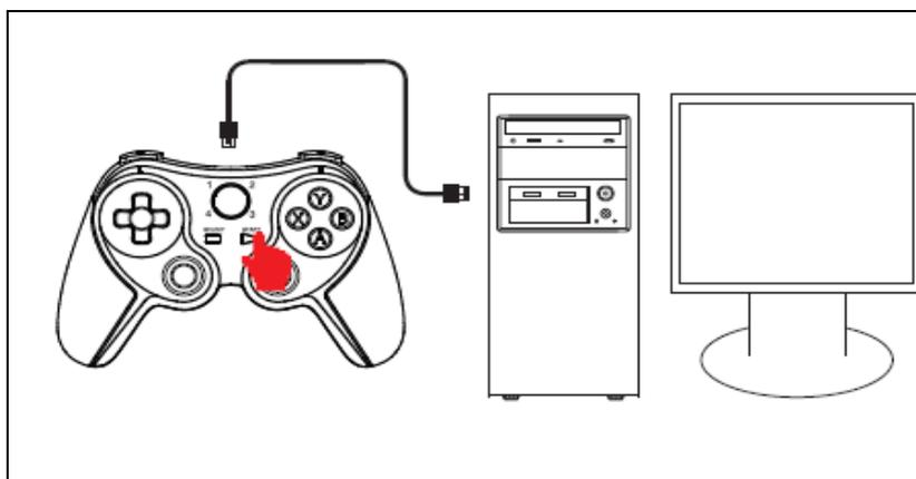
Appuyez sur le bouton Start (Démarrer) de l'appareil et branchez-le à un port USB de l'ordinateur à l'aide du câble USB.
