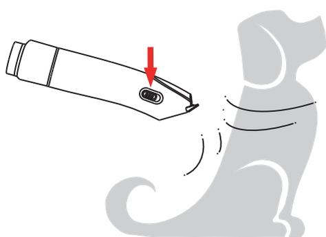
Faites glisser l'interrupteur d'alimentation pour allumer et éteindre la tondeuse. La tondeuse ne fonctionne que lorsque l'aspirateur est allumé.
