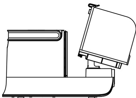
Réinstallez le bac à poussière en le remettant sur l'unité d'aspiration jusqu'à ce que le mécanisme de verrouillage soit audible.
