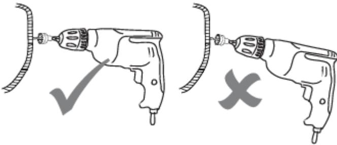
→→→ Lije ligeramente el orificio recién taladrado en el parachoques para obtener un acabado liso alrededor del borde.
