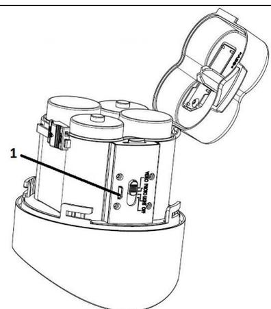
**Remarque:** Faites attention, lorsque vous réglez l'heure et la date, placez le bouton de fonction en position OFF. Une connexion au PC n'est établie qu'en position OFF.
