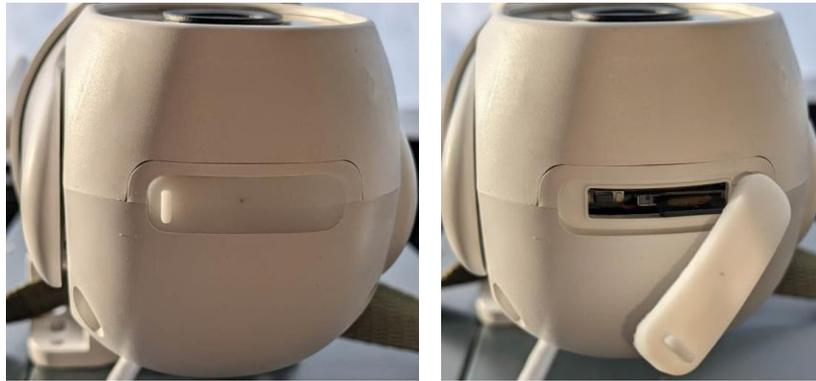
Nachdem Sie die MicroSD-Karte mit den Kerben nach links, wie im Bild zu sehen, eingeschoben haben, schließen Sie das Fach wieder.
