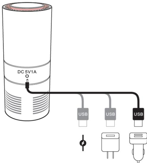
Conecte el USB/cable CC a una toma de corriente. (adaptador no incluido)
