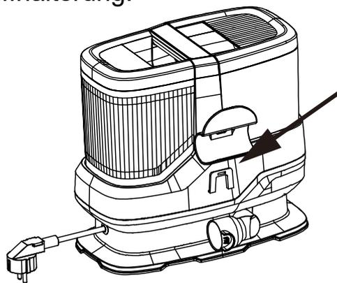
3. Den Wassertank durch Anheben nach oben abnehmen.
