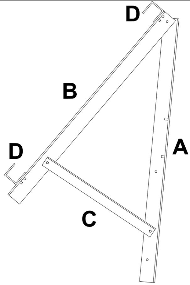
Fixez la partie D au sommet de la partie B. Fixez la partie D avec deux écrous hexagonaux M8. Serrez les écrous à l'aide d'une clé de 13 mm. La partie inférieure D peut être fixée à la partie B, mais doit être à nouveau détachée lorsque le support est accroché à la balustrade du balcon.
