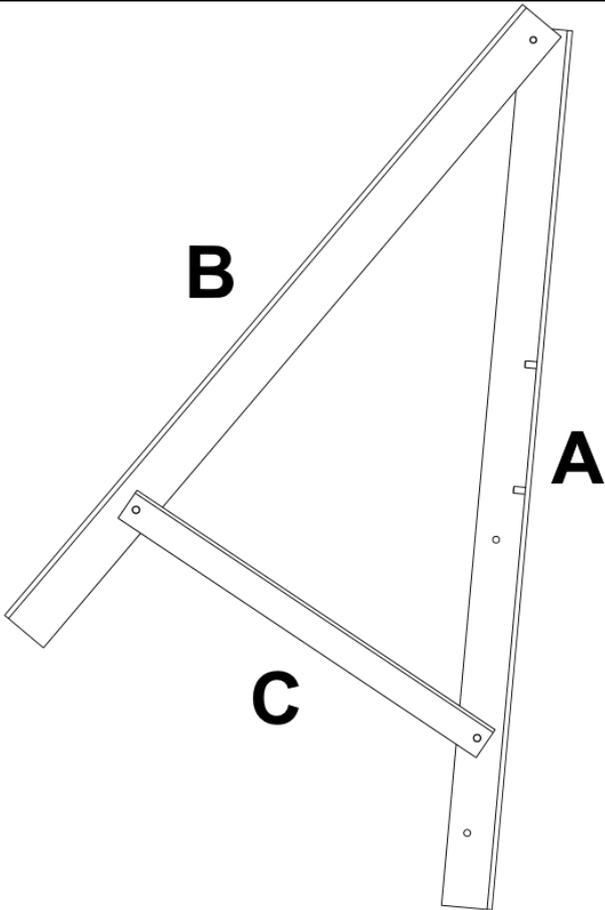
Utilisez la pièce C et insérez-la dans le trou de B et le trou central de A pour monter le support pour l'angle de 35°. Fixez la partie C avec deux écrous hexagonaux M8. Serrez les écrous à l'aide d'une clé de 13 mm. Serrez également l'écrou hexagonal M8 de l'étape 1.
