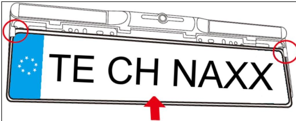
3. Setzen Sie die Clips der Abdeckleiste in die entsprechenden Löcher des Kennzeichenhalters ein und drücken Sie sie fest.
