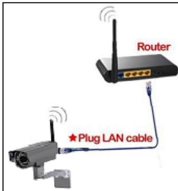
Zuerst vergewissern Sie sich, dass die Kamera über das Netzteil mit dem Strom verbunden ist. Jetzt verbinden Sie die Kamera mit dem LAN-Kabel an Ihren Router.
