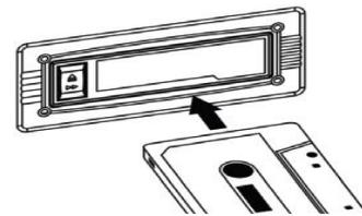
**WICHTIG bei Verwendung des Kassettendecks:** ● Achten Sie darauf, die Kassette in die richtige Richtung einzuschieben. ● Um eine Beschädigung der Kassette zu vermeiden, empfehlen wir Ihnen, diese aus dem Gerät nach der Wiedergabe zu entfernen.
